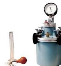
直读式混凝土含气量测定仪
