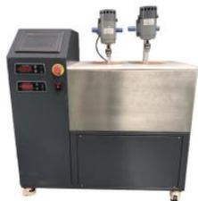
全自动水泥水化热测定仪
