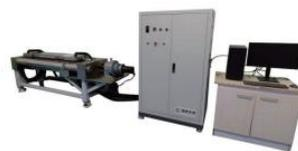
混凝土温度-应力试验机
