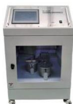
全自动混凝土凝结时间测定仪
