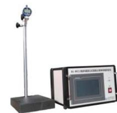
多通道立式混凝土膨胀收缩测定仪
