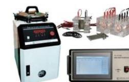
混凝土氯离子电通量测定仪
