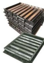
混凝土平板抗开裂试模
