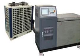
混凝土快速冻融试验机(-50°C)
